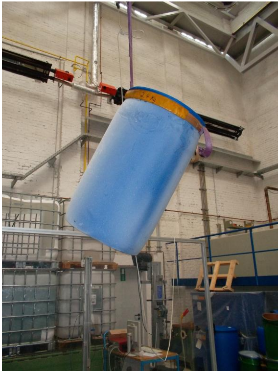
Abb. 10: Fass diagonal auf Bodenkante
