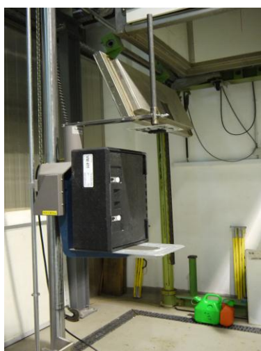
Abb. 16: Kiste, Fallposition "flach auf die kürzeste Seite"
