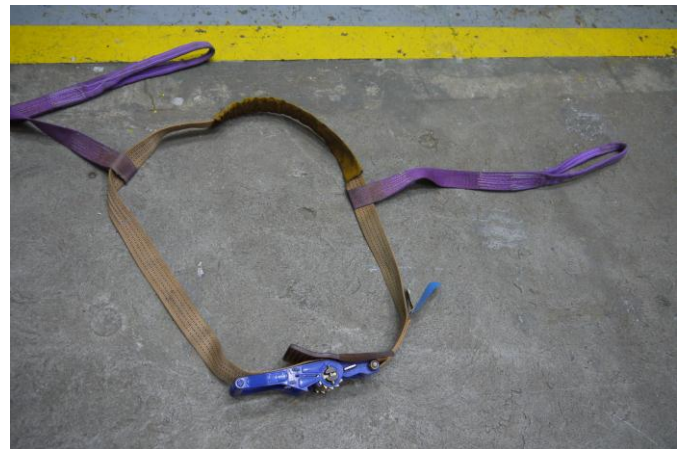
Abb. 4: Gurt zum geraden Heben eines Fasses
