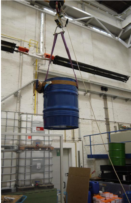
Abb. 5: Verwendungsbeispiel des Anschlagmittels aus Abb. 3
