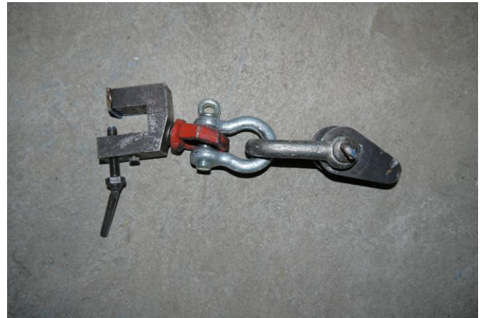
Abb. 2: Krampe zum diagonalen Aufhängen von Fässern
