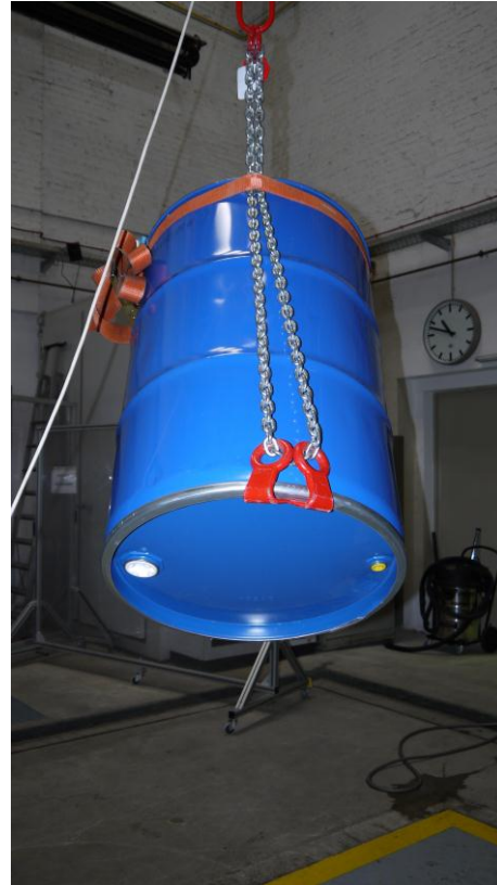
Abb. 6: improvisiertes Anschlagen zur Realisierung der gewünschten Fallposition
