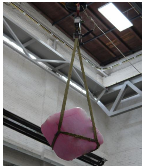
Abb. 8: Kanister im einmaschigen Netz
