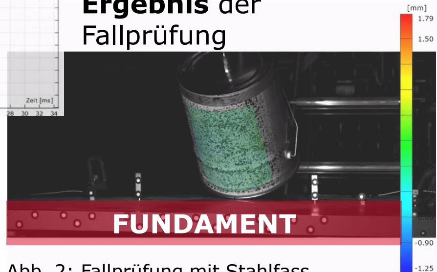
Abb. 2: Fallprüfung mit Stahlfass
