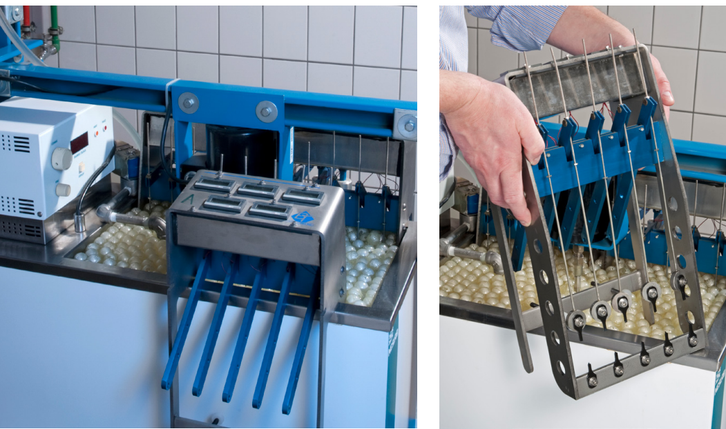
Abbildung 2. Apparatur zur Durchführung des NCTL-Tests (links), rechts der Probenhalter nach Entnahme aus dem Wasserbad, nachdem alle Probekörper gerissen waren.
