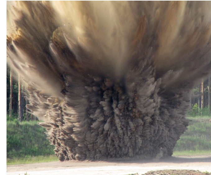
Umsetzung einer vergrabenen Ladung
