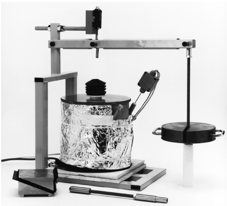
Abb. 2: Prüfeinrichtung für einen Zeitstand-Scherversuch in der Variante als modifizierter Schiefe-Ebene-Versuch (links). Probenhalterung eines Schiefe-Ebene-Versuchs (rechts). Die Dichtungsbahn wird auf dem unteren Keil fixiert. Als Reibungspartner dient ein Vliesstoff, der auf dem oberen Keil befestigt wird.
