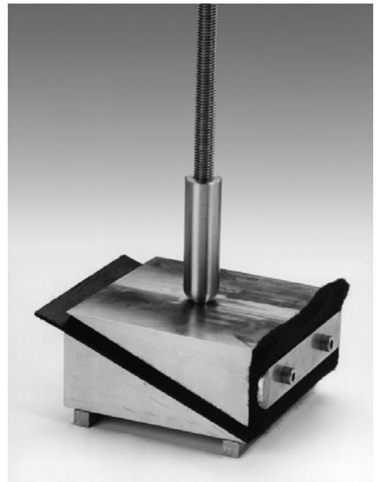
Abb. 1: Prüfeinrichtung für einen Zeitstand-Scherversuch in der Variante als modifizierter Scherkastenversuch.
