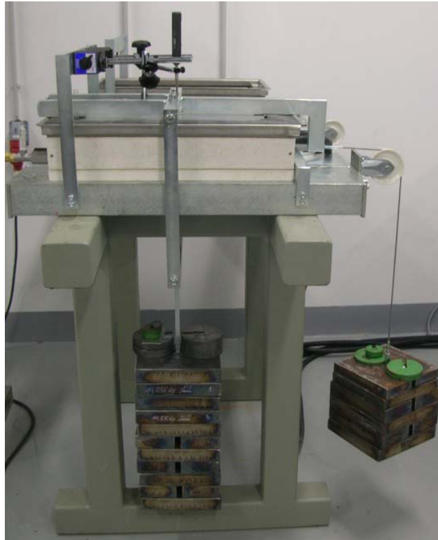
Abb. 1: Prüfeinrichtung für einen Zeitstand-Scherversuch in der Variante als modifizierter Scherkastenversuch.
